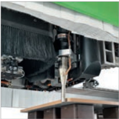
Grupo soplador de aire frío o caliente para reavivar el color del canto.
