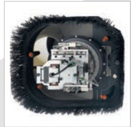
Grupo soplador de 4 salidas utilizable también con los grupos de acabado del canto.
